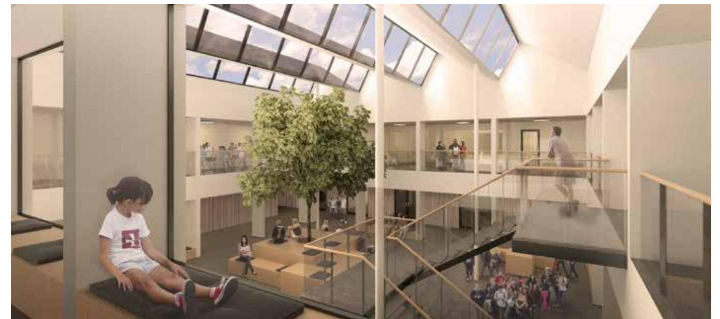
Atrium bliver overdækket med ovenlys og åbnet til siderne, og der etableres en trappe mellem de to etager.
